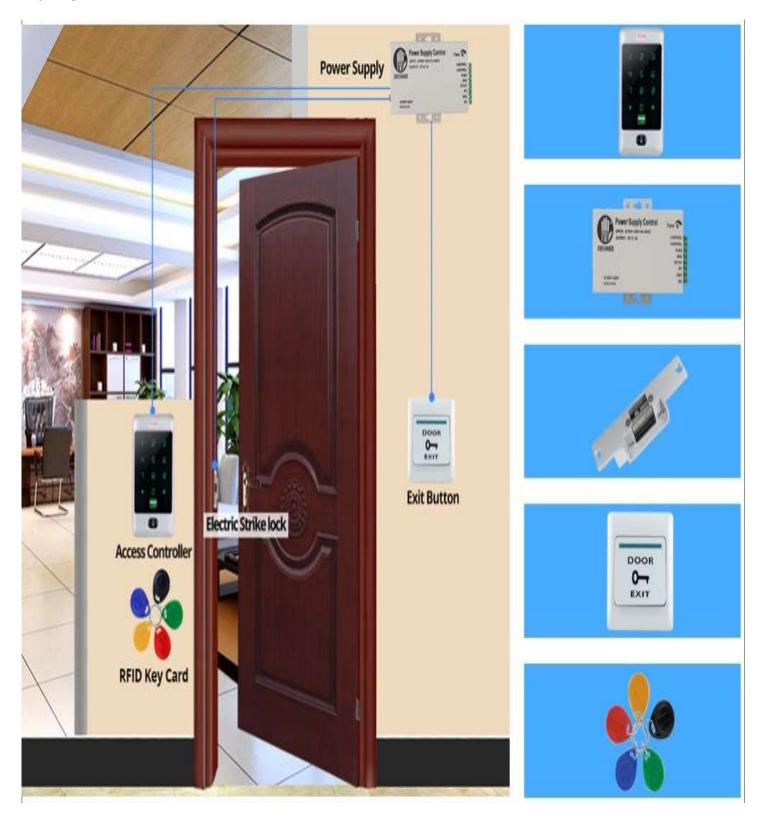
*Kit 2:* Controlador de acceso + fuente de alimentación + botón de salida + RFID Keyfobs + cerradura eléctrica del perno.
